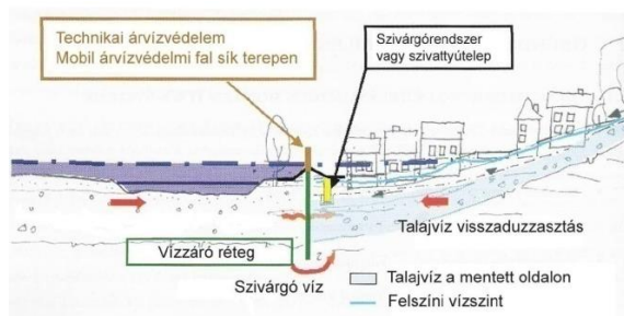
4. ábra. A mobil árvízvédelmi falak talajra gyakorolt hatásai
